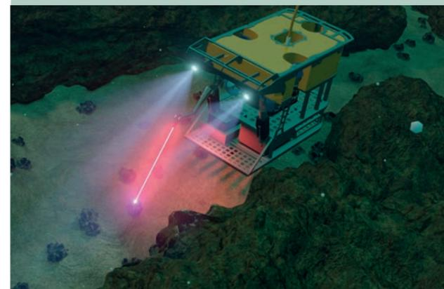
Illustration eines Tauchroboters, der mittels Laser-induzierter Plasmaspektroskopie (LIBS) die umweltschonende Analyse von Materialien in der Tiefsee ermöglicht. Illustration: INP
