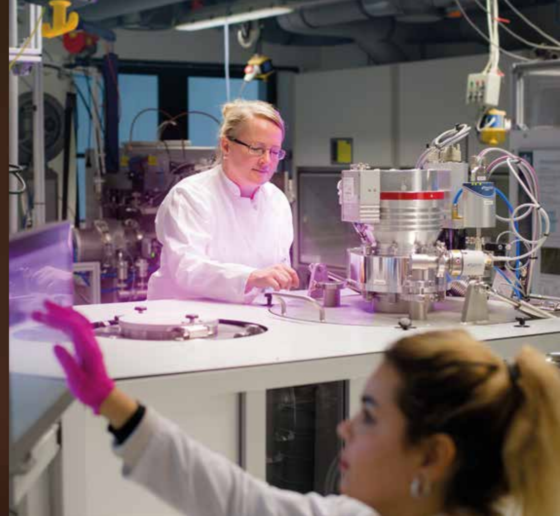
Links: In diesem Reaktor wird unter Vakuum ein Röhrensubstrat durch einen am INP entwickelten Magnetron-Sputterprozess beschichtet. Die aufgetragenen elektrokeramischen Dünnschichten sind das Herzstück der Festkörper-Ammoniaksynthese.
