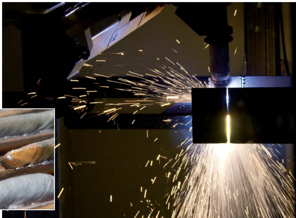
Ein Schweißautomat im Einsatz. Kleines Bild: Schweißnaht. Fotos: INP
