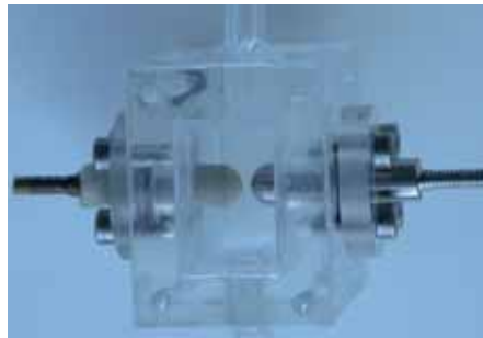
In dieser Entladungszelle wurde die Mikroentladung in Argon gezündet. Foto: Manuela Glawe
